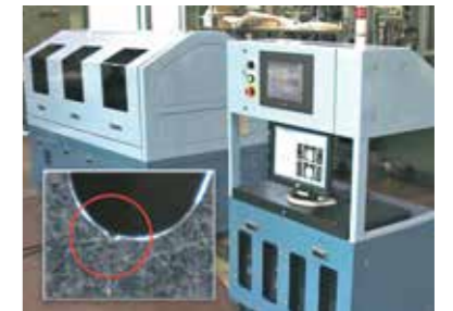
工程中を流れるワークの傷検査装置
